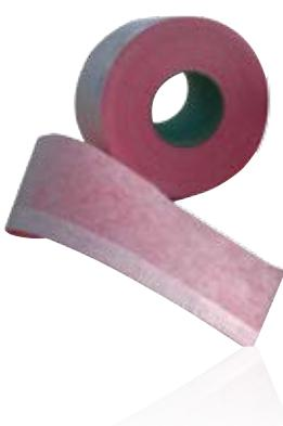
**SLO** Za hitro in varno tesnjenje zaključnih reg med okni ali zunanjimi vrti ter fasado. Rego med oknom in steno zapolnimo s 3MONT PU FLEX peno ali Tekapur PU peno. Na notranji strani zatesnimo s 3MONT TRAK IN (rdeč = paronepropusten), na zunanji strani pa s 3MONT TRAK OUT (bel = paropropusten). Elastična traka tvorita sistem tesnilnih trakov, ki omogoča doseganje velike prihranka energije.
