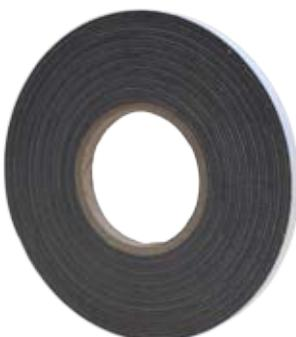
**SLO** Za tesnjenje dilatacijskih reg z zunanje strani pri nizkih in visokih gradnjah. Je samoekspandirajoči impregnirani tesnilni trak, trajno fleksibilen in paroprepusten ter na eni strani samolepilen.
