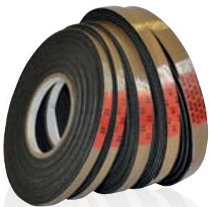
**SLO** Za tesnjenje dilatacijskih reg z zunanje strani pri nizkih gradnjah do 5 etaž. Je samoekspandirajoči impregnirani tesnilni trak, trajno fleksibilen in paroprepusten ter na eni strani samolepilen.
