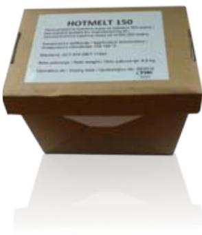
**SLO** Je termoplastična tesnilna masa formulirana posebej za izdelavo IZO stekel. Priporočena temperatura segrevanja pri nanašanju je med 130 °C in 160 °C. Nanaša se z uporabo Hotmelt extrudorja z prednastavljivo temperatujo gretja in tlaka, ki ustreza pogojem v proizvodnji. Po nanosu se takoj povrne struktura mase, kar omogoča hiter transport. Izdelek je testiran po standardu JC/T 914 GB/T 11944.
