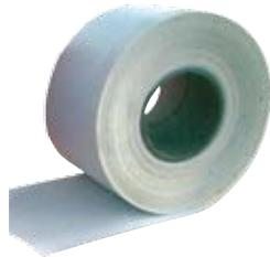
**SLO** Za hitro in varno tesanjenje zaključnih reg med okni ali zunanjimi vrti ter fasado. Rego med oknom in steno zapolnimo s 3MONT PU FLEX peno ali Tekapur PU peno. Na zunanji strani zatesnimo s 3MONT TRAK OUT (bel = paroproposten), na notranji pa s 3MONT TRAK IN (rdeč = paroneproposten). Elastična trakova tvorita sistem tesnilnih trakov, ki omogoča doseganje velikega prihranka energije.
