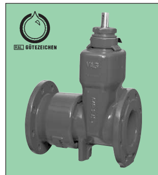
VAG BETA® 200 TS Zamenski zasun, meko zaptivanje PN 10/16 - DN 80...300 - voda
