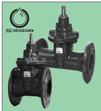
Zasun VAG EKOpus ® Specifikacija za zemlje Zaliva PN 10/16/25 - DN 40...500 - voda
